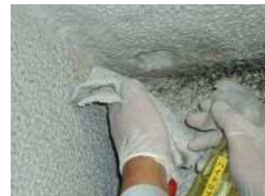
④採取箇所へ飛散防止剤の噴霧
