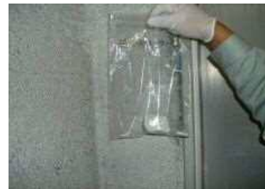
③採取したサンプルをチャック付 ビニール袋に入れ密閉
